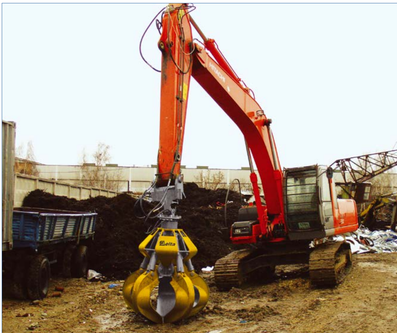
Рис. 10. Проверка грейфера перед запуском
